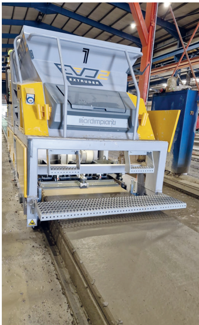
Два экструдера EVO2 на заводе Creagh Concrete
